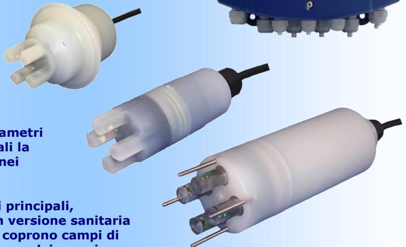
T30 è un sensore di torbidità di ultima generazione, che dispone di due emettitori e due ricevitori posizionati rispettivamente a 90°. Grazie ad un sistema di elaborazione razionale delle misurazioni effettuate, consente un elevato incremento della sensibilità di misura. La tecnologia combina due principi ottici distinti in un unico trasduttore con elaborazione digitale, ovvero attenuazione luminosa e diffusione a 90°.
